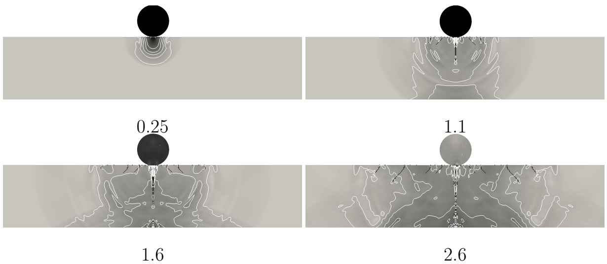
Рис. 9: Нормальный удар шарика о стекло (представлены картины разрушения в разные моменты времени). Черными линиями отмечены образовавшиеся трещины, белыми - изолинии скоростей. Насыщенность цвета соответствует также модулям скоростей.
