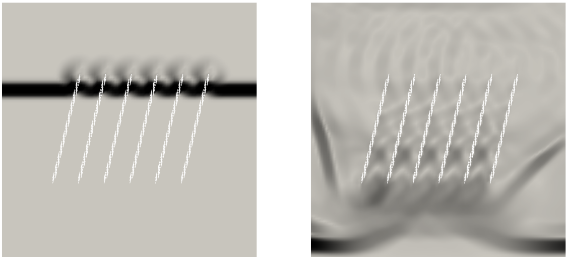
Рис. 15: Прохождение плоской волны через кластер наклоненных газонасыщенных трещин.
