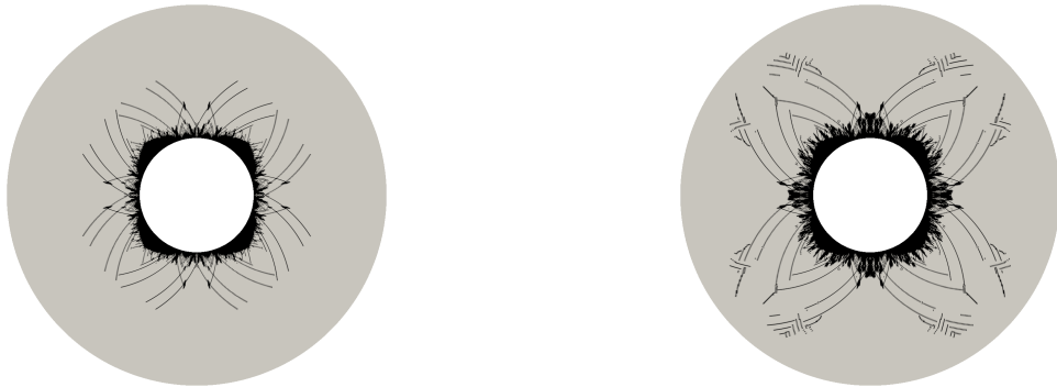
Рис. 5: Рост трещин в пластине.
