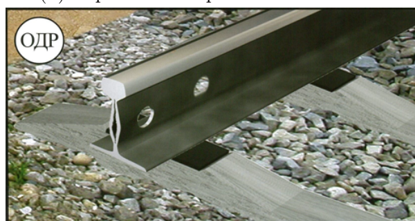
(d) Расслоение шейки рельса
