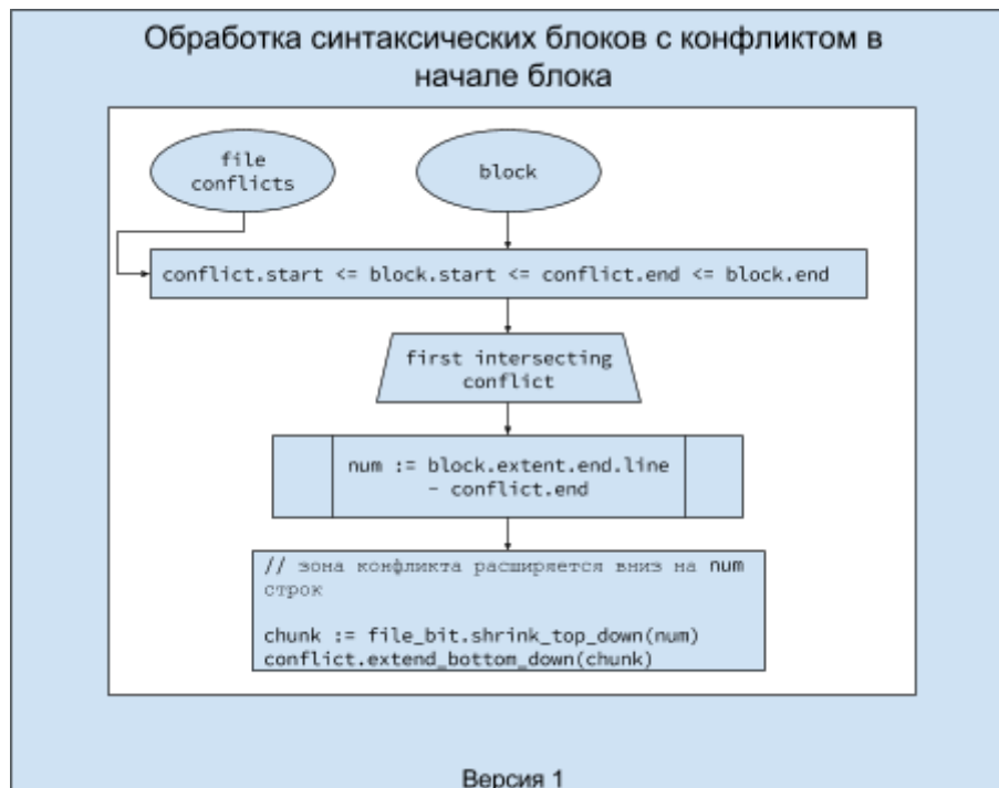
Рис. 7 Схема работы процедуры обработки синтаксических блоков с конфликтами в начале блока версии 1
