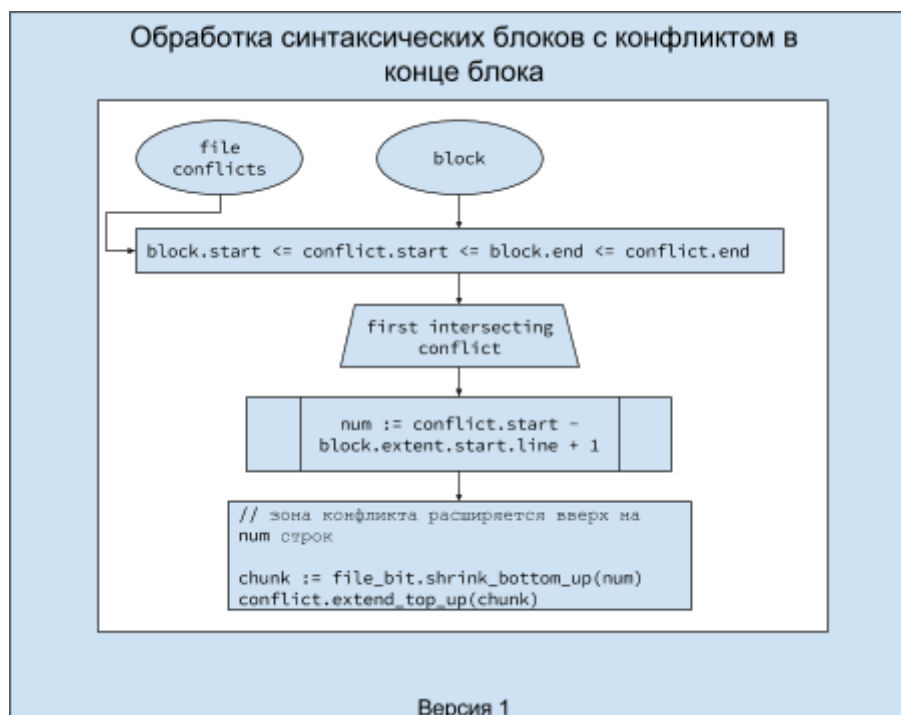
Рис. 6 Схема работы процедуры обработки синтаксических блоков с конфликтами в конце блока версии 1
