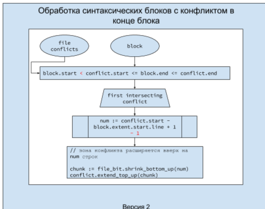
Рис. 8 Схема работы процедуры обработки синтаксических блоков с конфликтами в конце блока версии 2
